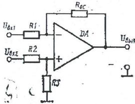
10. Визначити вихідні опори операційного підсилювача : а) по входу 1; б) по входу 2. Що потрібно змінити у схемі для забезпечення рівності вхідних опорів по входу 1 и по входу 2? Опори резисторів R1 = R2=R3 = 5 кОм, ROC=50 кОм.
