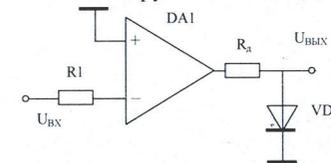
6. Побудувавши часові діаграми керуючої напруги на варикапі (рис. – ВАХ варикапа) і зміни бар'єрної ємності  $p - n$  – переходу, визначити діапазон зміни ємності. Напруга зміщення  $U_{см}=15$  В. Вхідна напруга  $U_{вх}=10\sin(120t)$ .
