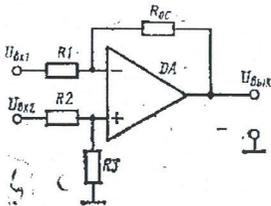
11. На інвертуючий вхід 2 операційного підсилювача типу К153УД2 (A=105, ЕП=15 В) надходить постійна напруга UBX2=+2 В, а на неінвертуючий вхід 1— постійну напругу UBX1 =+1 В. Визначити напругу на виході підсилювача. Чи зміняться вихідні напруги підсилювача, якщо на вхід 2 подати напругу +3 В, залишивши без змін напругу на вході 1?
