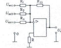
5. Знайдіть  $U_{ВЫХ}$ , якщо  $U_{ВХ} = -5$  В у схемі на рис. Напруга насичення ОП DA1  $U_{нас} = \pm 10$  В. Прямий спад напруги на діоді УДПР=0,5 В.
