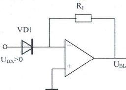
19. Між входами ОП (рис.) включений фотодіод ФД, струм якого складає 5 мА. Який резистор слід включити в коло ОС, щоб отримати на виході напругу 5В?
