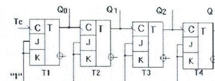
39. Намалуйте схему лічильника с  $K_{сч}=7$ , використовуючи чотирирозрядний лічильник (рис.).
